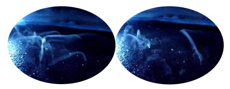
Nous avons essayé de dévier les électrons en plaçant un aimant sous la plaque : nous n'avons pas pu observer d'effet ... mais notre éclairage n'est vraiment pas optimal !
