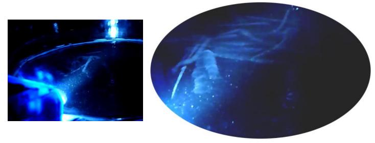
On observe des traces : des alphas, des bêtas et quelques rayons cosmiques Avec ajout d'une bouffée de thoron, on voit bien les "V" que forment les alphas du radon et du polonium 216.
